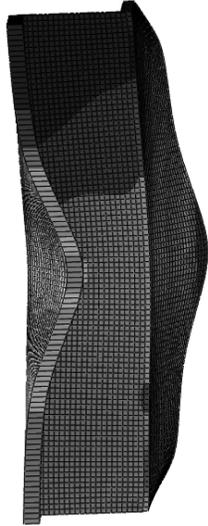
图9 “Z”型长桁有限元分析变形图
