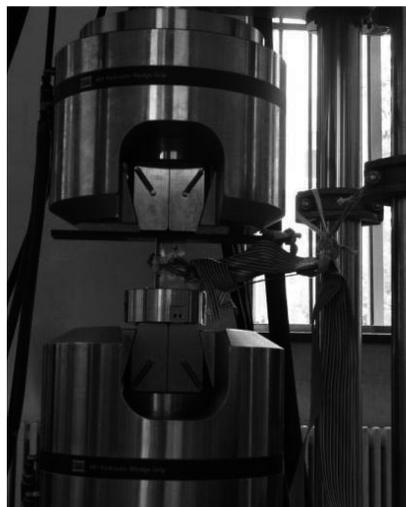
图7 “T”型、“Z”型长桁试验件安装照片
