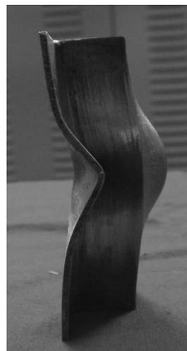
图8 “Z”型长桁典型试验破坏照片
