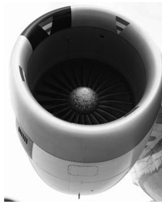
图 8 试验后发动机整流锥局部结冰示意图
