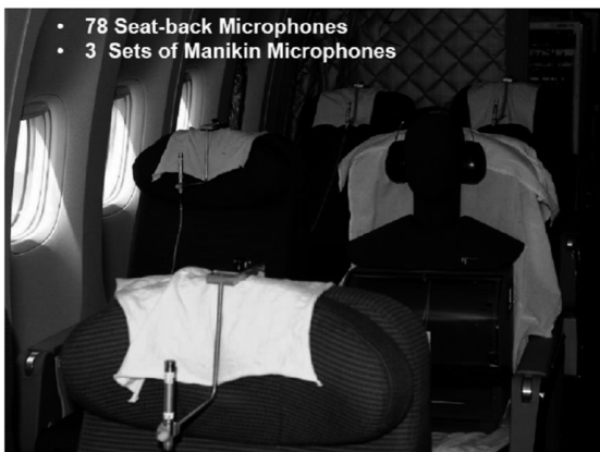
图 15 舱内噪声测量及人体主观评价测量
