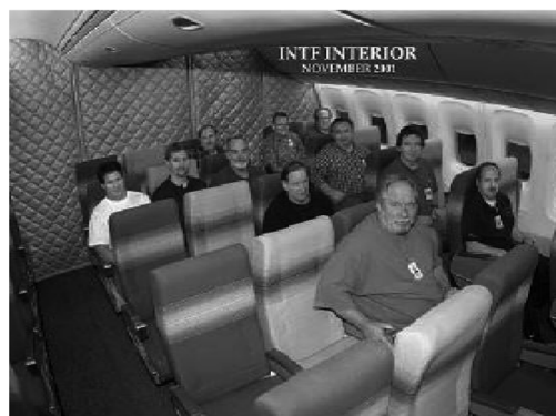
图 11 机身舱段吸声性能声学试验
