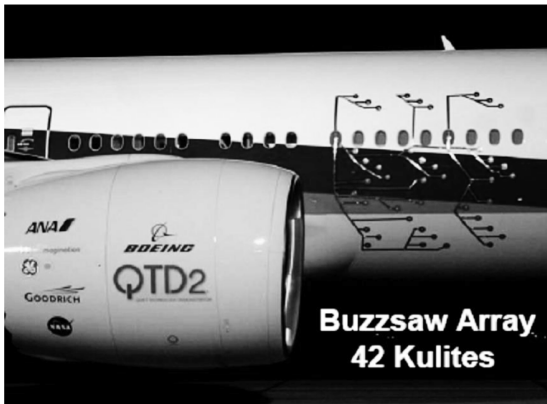
图 14 机身表面风扇噪声的测量
