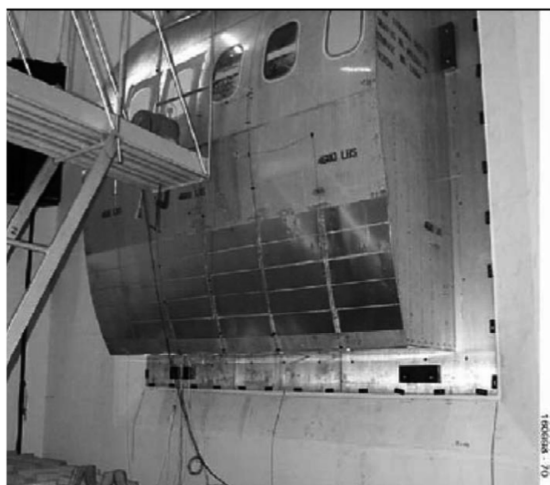
图 9 飞机侧壁板隔声测试
