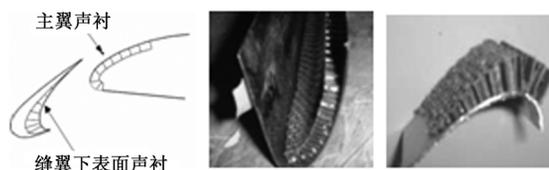
图 6 缝翼安装声衬
