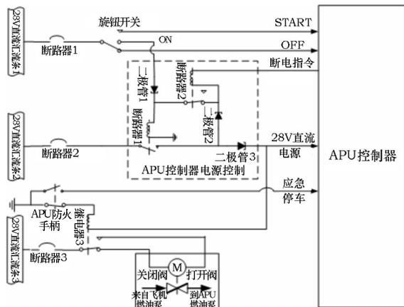
图 3 实现 APU 应急停车的电气原理图
