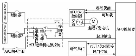
图 4 APU 起动控制电气原理图
