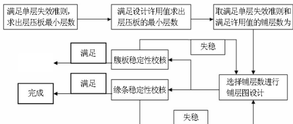
图4 长桁铺层设计步骤图
