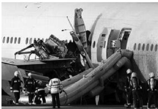
图 1 Boeing 777 客机由于燃油系统管路结冰而致使飞机迫降
