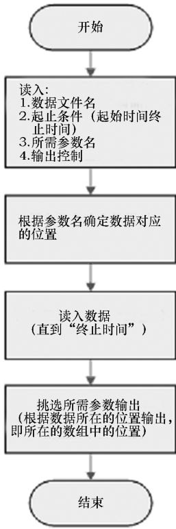
图1 读取数据程序流程图
